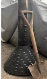
ネットで購入した燻炭器。直径1m、高さ1.2m、SUS製。煙突とじょうご部分に空気穴がある。
