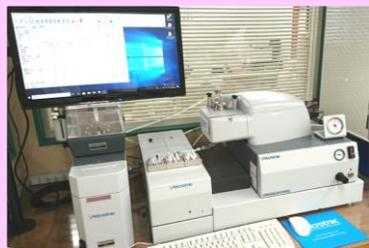
測定原理：レーザー回折散乱法
