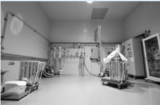
加工室は1製品1部屋体制で徹底洗浄しコンタミを防止
